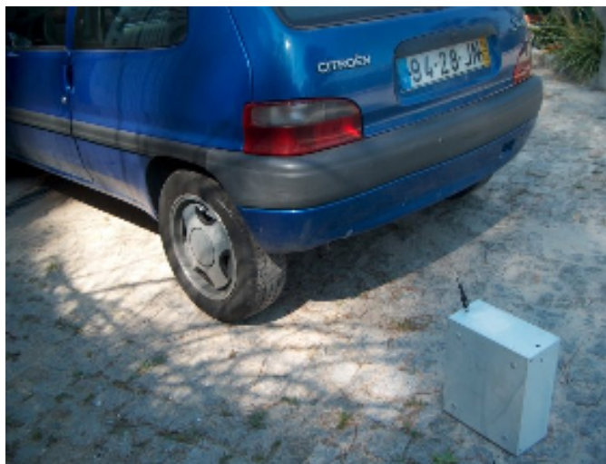
Figura 16 – Recolha de ar ambiente junto ao escape de veículos automóveis.
